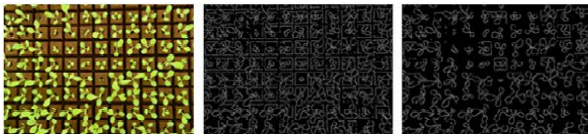
(a)原始影像 (b)典型 Canny 邊緣偵測 (c)結合 Otsu 計算門檻值的 Canny 邊緣偵測
